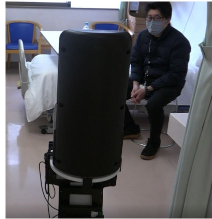
④ロボットがベッド横に向かう ※病室ごとに止まる地点が 決めてある)
